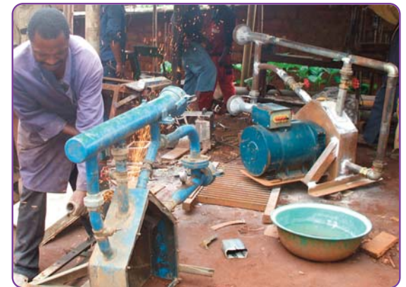
Fabrication des turbines par ADEID pour les micro centrales hydro électriques
